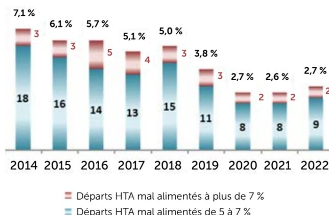
En 2022, sur les 402 départs HTA alimentant l'ensemble la concession, 11 subissent des chutes de tension maximales supérieures à 5 % dont 2 connaissent des chutes de tension supérieures à 7 % (2 également en 2020 et 2021).
